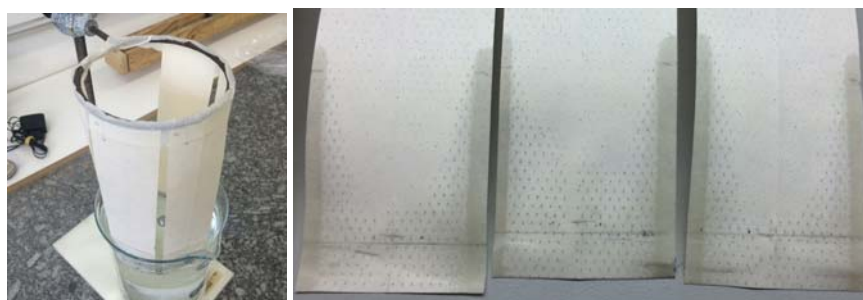
Figura 3 – Ensaio de ascensão capilar
