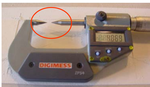
b. Micrômetro de ponta cônica (utilizado no ensaio de espessura)
