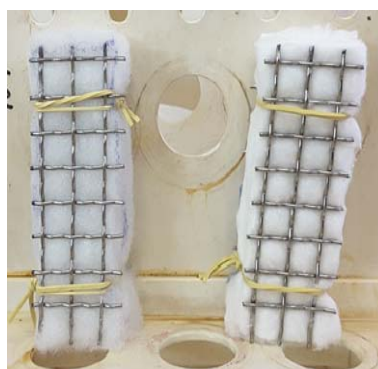
b. Ensaio de contribuição à corrosão do aço
