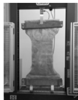
c. Ensaio de resistência à tração longitudinal
