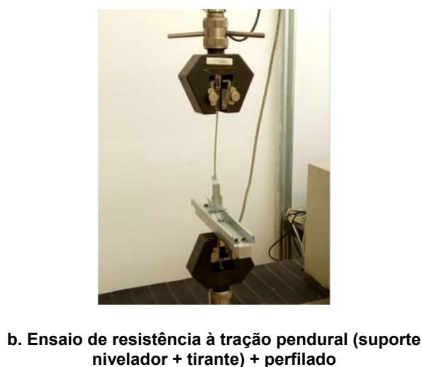
Figura 5 – Tipos de acessórios e detalhe do ensaio de resistência à tração
