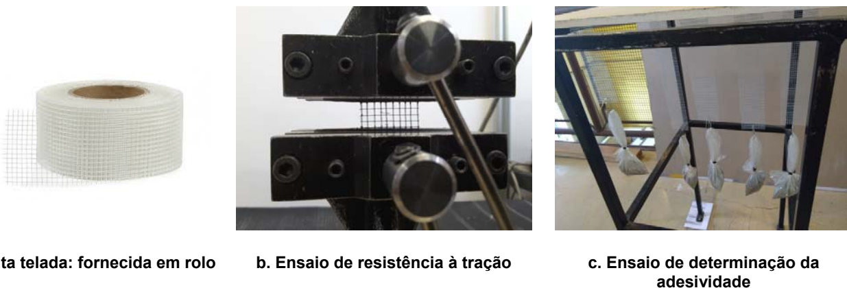
Figura 10 – Fita telada autoadesiva e exemplos de ensaios
