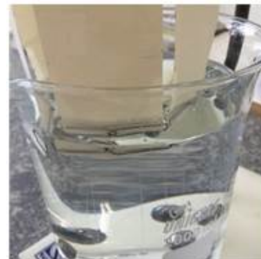
c. Ensaio de estabilidade dimensional
