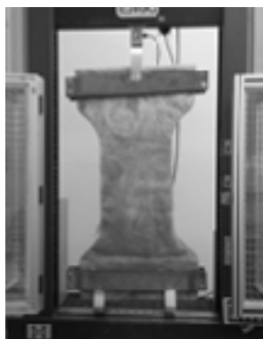
b. Ensaio de resistência à tração longitudinal
