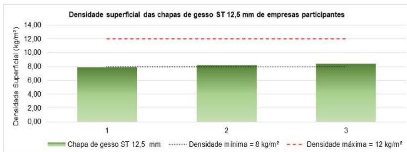
Figura 12 – Resultados da determinação da densidade superficial das amostras de chapas de gesso ST 12,5 mm avaliadas
