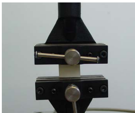
b. Ensaio de resistência à tração
